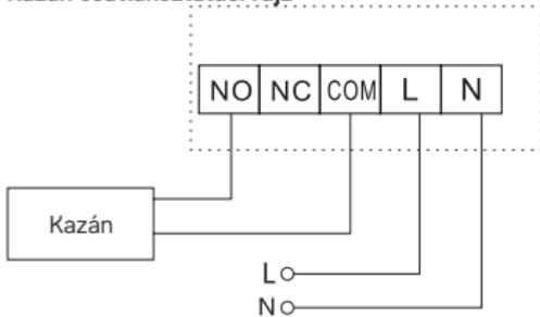
Az előszerelt csatlakozó nem kerül bekötésre.
