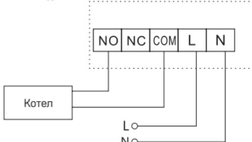
Попередньо встановлений провідний з'єднувач не буде підключений.
