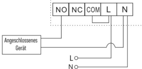
**Anschlussschema für den Kessel**
