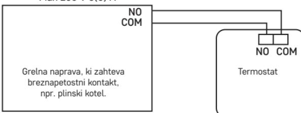
\* V primeru, da gre za kotel NC, naj je termostat nastavljen v način HLAJENJE (COOLING).
