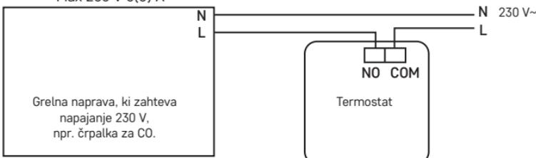
\* V primeru, da gre za kotel NC, naj je termostat nastavljen v način HLAJENJE (COOLING).
