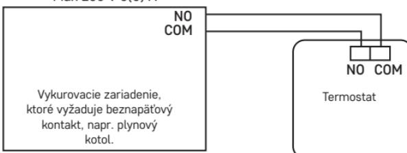
\* V prípade, že sa jedná o kotel NC, termostat by mal byť nastavený v režime CHLADENIA (COOLING).
