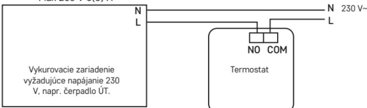
\* V prípade, že sa jedná o kotel NC, termostat by mal byť nastavený v režime CHLADENIA (COOLING).
