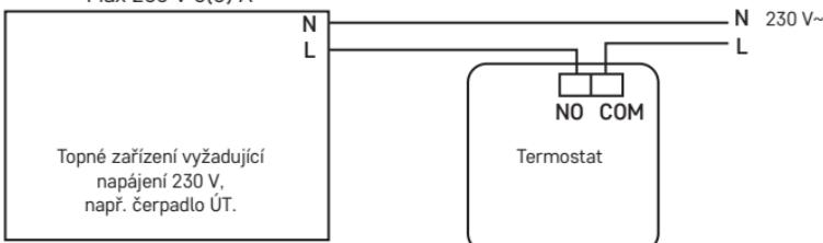
\* V případě, že se jedná o kotel NC, termostat by měl být nastaven v režimu CHLAZENÍ (COOLING).
