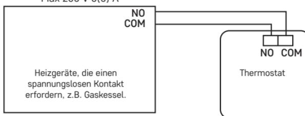
\* Falls es sich um einen NC-Kessel handelt, sollte der Thermostat im Modus KÜHLUNG (COOLING) eingestellt sein.
