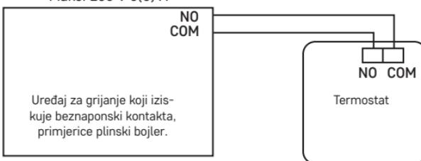
\* Ako se radi o bojleru NC, termostat treba postaviti u način HLAĐENJE.
